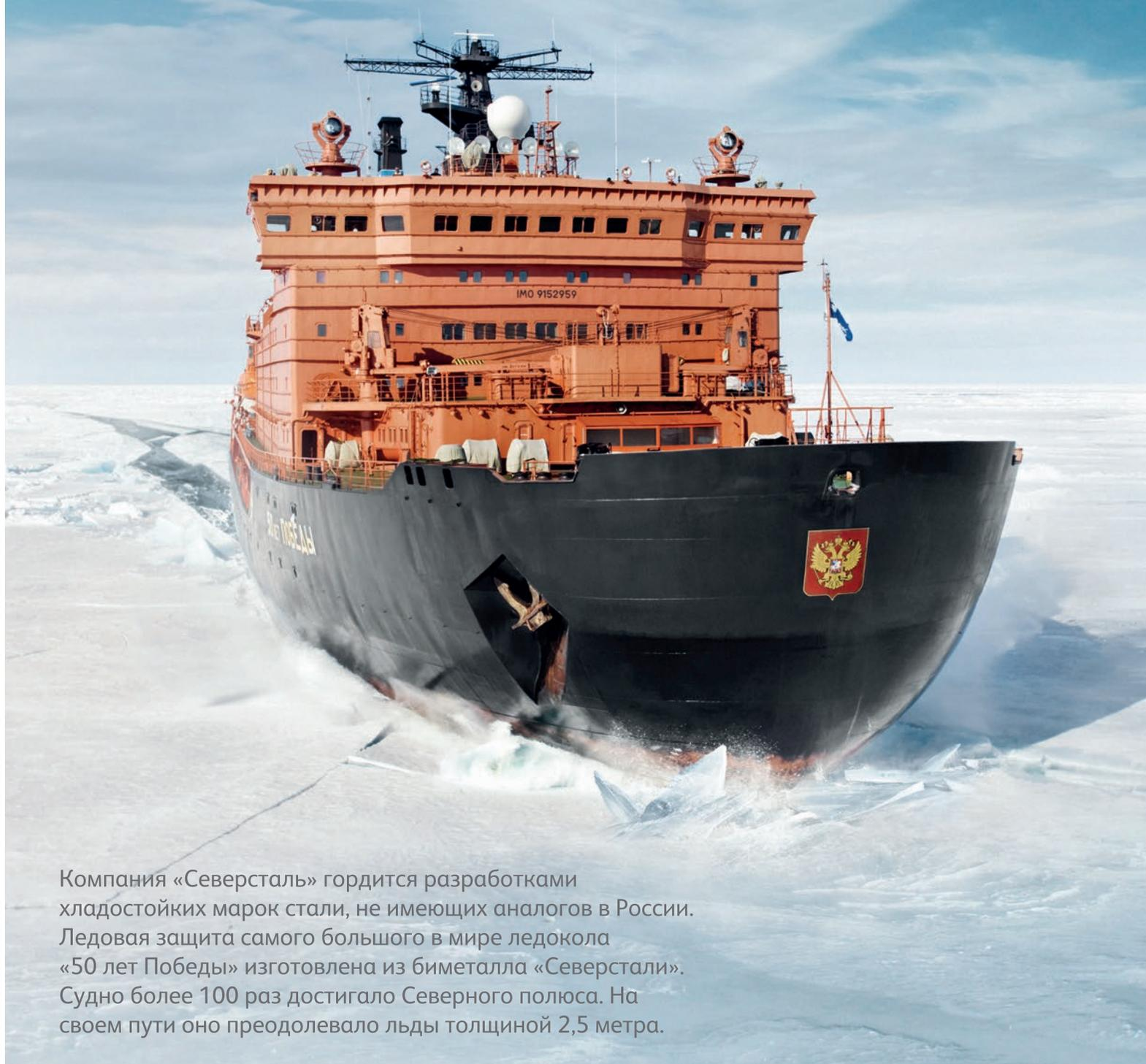
Компания «Северсталь» гордится разработками хладостойких марок стали, не имеющих аналогов в России. Ледовая защита самого большого в мире ледокола «50 лет Победы» изготовлена из биметалла «Северстали». Судно более 100 раз достигало Северного полюса. На своем пути оно преодолевало льды толщиной 2,5 метра.
